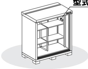
部品箱内の「型式ネーム」シールを側板右上部内側に貼り付けます。
