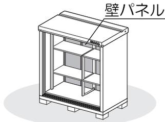
①壁パネル(大)を側板後ろにはめ込み、縦方向(a)をボルトとパッキン付ネジ板で取り付け、横方向(b)をボルトとネジ板で取り付けます。
