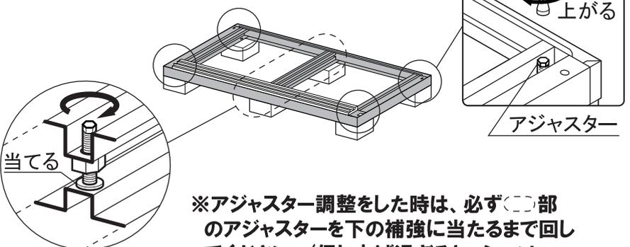
※アジャスター調整をした時は、必ず( )部のアジャスターを下の補強に当たるまで回してください。(但し上げ過ぎると、シーソーのようになりますので注意してください。)
